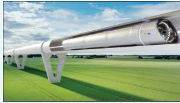
هایپرلوب شامل لوله‌های کم‌فشار است که در آن کپسول‌هایی برای جایه‌جایی افزاد و بار می‌توانند با هر دو سرعت کم و زیاد جایه‌جایشوند. کپسول‌های کمک شتاب‌دهنده خطی مغناطیسی که در ایستگاه‌های مختلف روى لوله کم‌فشار با این روش روتورهایی که در هر کپسول نصب شده است، شتاب می‌گيرند. به اين ترتیب امكان جایه‌جایی در مسیرهای طولانی از چند ساعت به چند دقیقه می‌تواند کاهش یابد.
