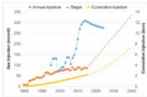
شکل ۳: داده‌های تاریخی و برآوردهای آتی از تزریق سالانه گاز و اهداف پیشین آن (محور سمت چپ) و تزریق گاز انباشته (محور سمت راست) به مخازن نفت خام ایران. اهداف سالانه تزریق گاز جهت حفظ فشار در ۲۴ میدان نفتی در حال کاهش ایران
